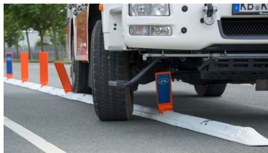
Abbildung 10: Überfahren der horizont Leitschwelle möglich
